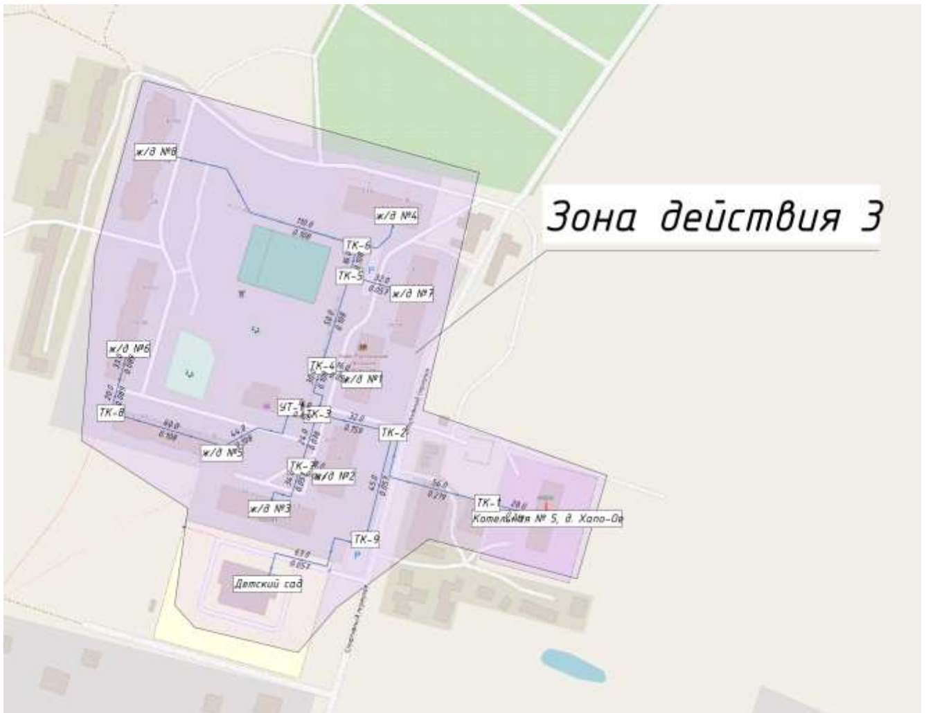
Рисунок 5. Зона действия котельной №5, д. Хапо-Ое
