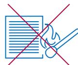
Не проверяйте тягу в дымовом и вентиляционном каналах с помощью огня.
