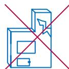
Не используйте печи с трещинами на дымоходе и в кладке.
