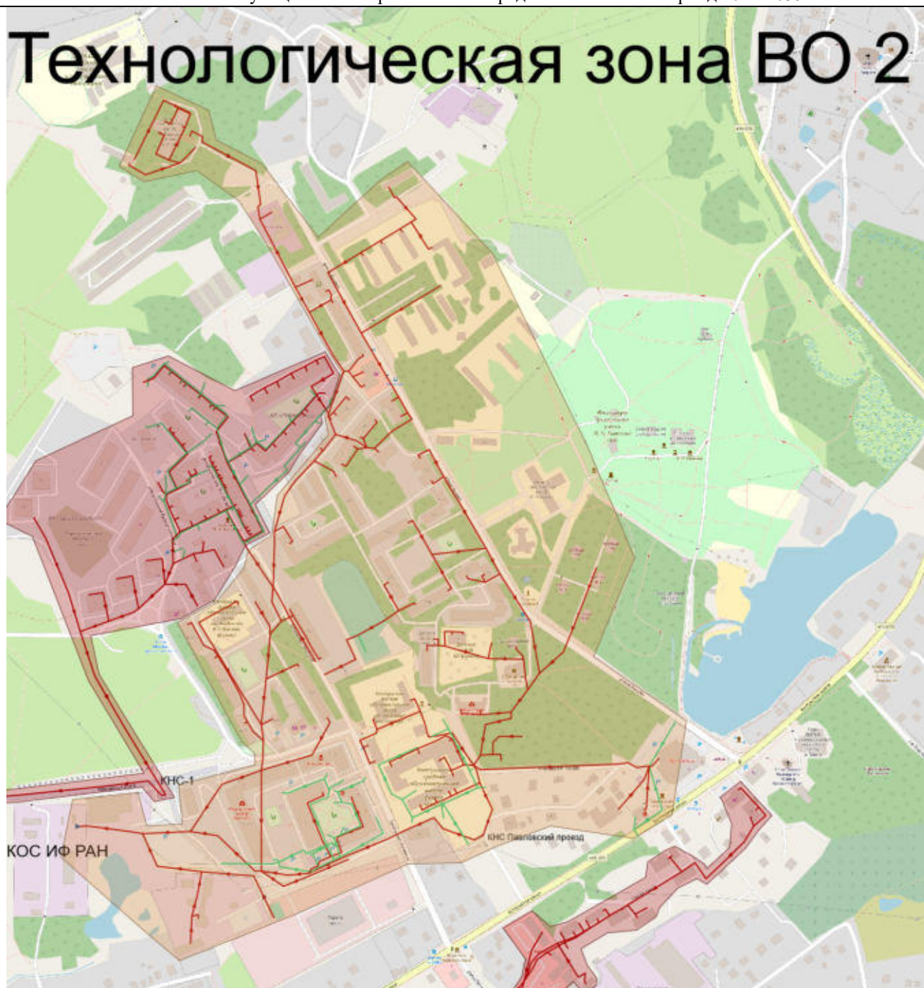
Рисунок 24 Сети хозяйственно-бытовой и ливневой канализации в технологической зоне ВО 2 (зона выделена желтым цветом)
