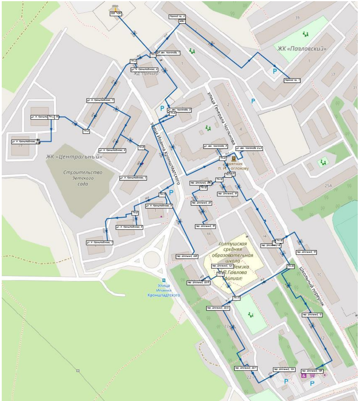
Рисунок 16. Схема тепловых сетей от котельной ООО «КЭЖ», д. Старая (зона действия №10)
